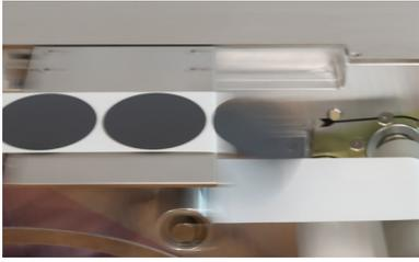
Durch die bewegliche Abziehkante wird das Trägerpapier ohne Anforderungen an die Haltekraft des Sauggreifers prozesssicher vom Stanzteil entfernt.
